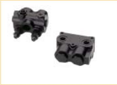
**Válvula Divisora de Fluxo com Vazão Prioritária:** Pressão máxima 210 bar. Fluxo prioritário regulável de 0 a 57 l/min, com compensação de pressão.
